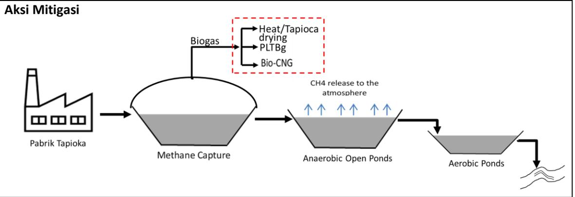
Gambar 2. Boundary aksi mitigasi, Methane Capture dilanjutkan kolam anaerobic dan aerobic terbuka
